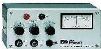
Прибор для поиска места замыкания на землю ESG 80-2, состоит из высокочувствительного гальванометра. Главная область применения - в локализации дефектов оболочки в кабелях с ПЭ и ПВХ изоляцией. С помощью установки указателя в центральное положение кроме величины измеряемого напряжения можно определить и его полярность. По полярности можно определить направление, в котором находится неисправность. Помехи постоянного напряжения подавляются с помощью компенсационной схемы.
