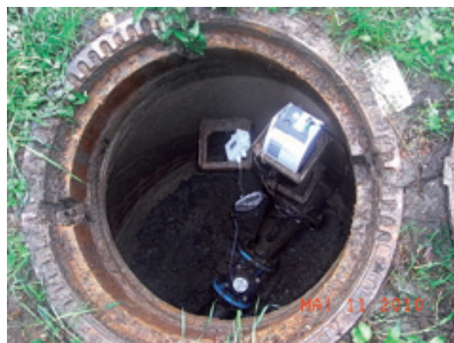
Sebalog D- при измерении расхода жидкости в Германии
