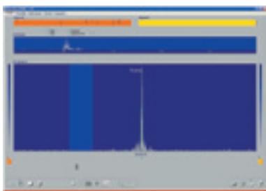
Сконцентрируйтесь на самом главном! При помощи подавления пика отсекаются помехи из корреляционной характеристики. Благодаря этому можно просто выделить утечку в данный момент или другие источники шумов.
