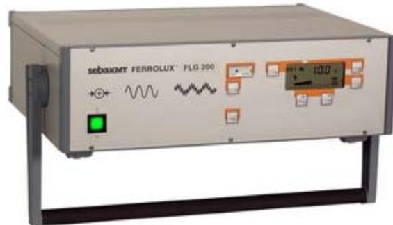
В комбинации с новым приемником звуковой частоты FLE 10 может производиться поиск трассы по методу SuperMax и определение направления распространения сигнала SignalSelect. С помощью генератора производится измерение импеданса шлейфа, при котором определяется величина и фаза выходного напряжения и выходного тока. Возможна длительная работа на емкостной нагрузке (изолированные газопроводы), а также на индуктивной нагрузке (короткозамкнутые кабели).
