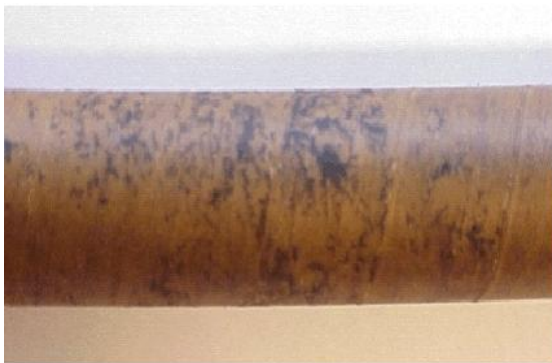
Рис.5: Следы ЧР в промежуточных слоях бумаги
